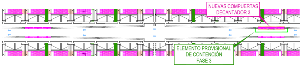
Figura 14. Fase 3 de ampliación de entrada a decantadores
