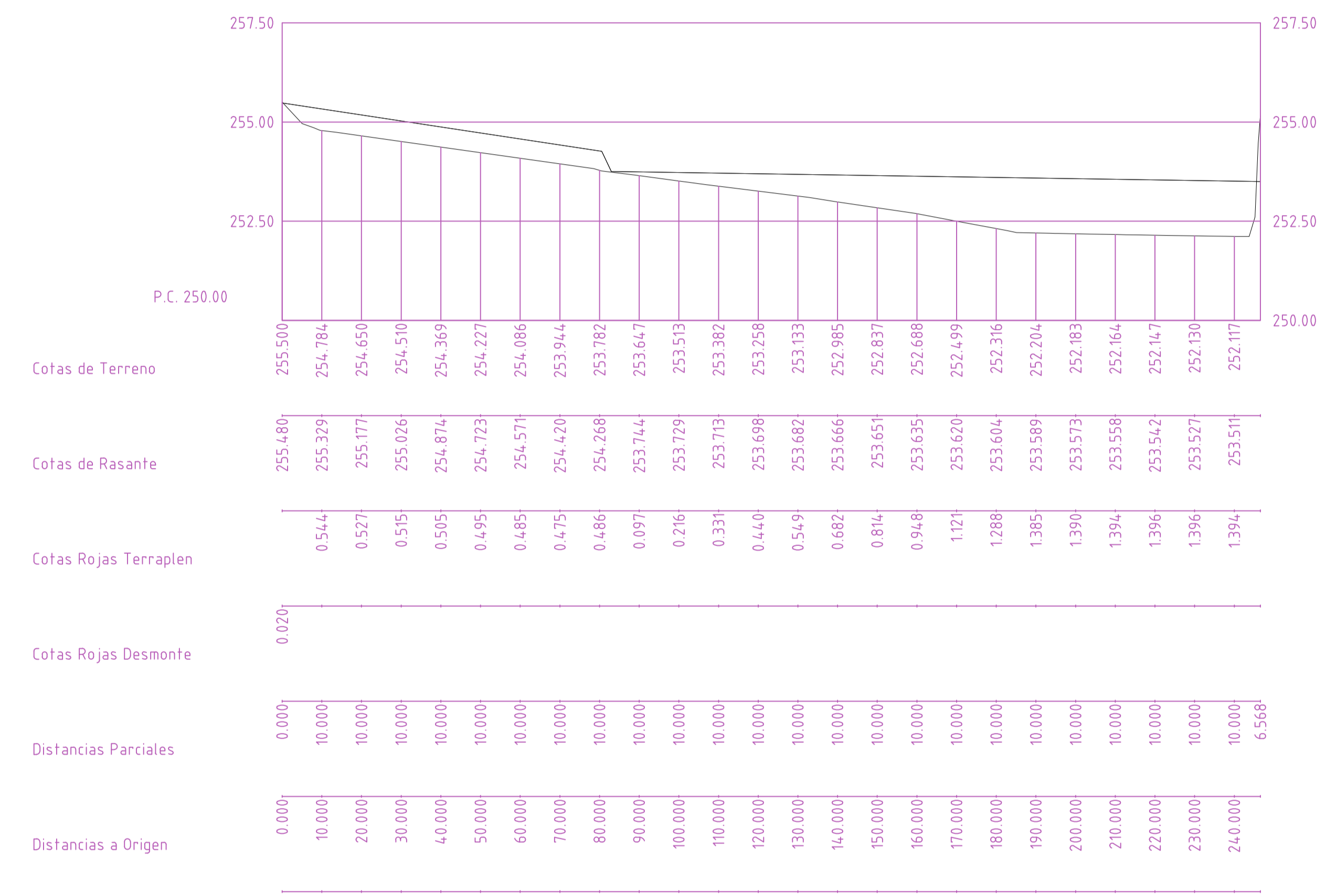
PERFIL LONGITUDINAL E. HORIZONTAL 1/ 1000 E. VERTICAL 1/ 100
