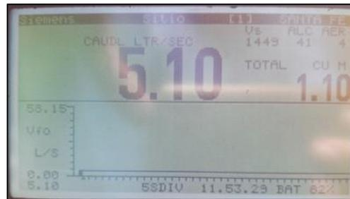
Se realizó la instalación del caudalimetro digital para medir el caudal de explotación del pozo el cual arrojo un valor de explotación de 5.10 litros por segundo
