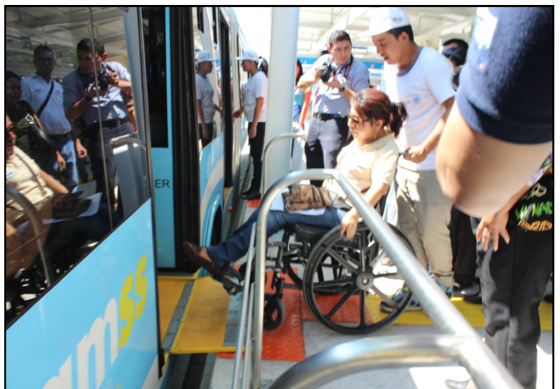
Persona en silla de ruedas haciendo uso de la rampa extensible de acceso en la puerta que indica el ingreso para este tipo de movilidad.
