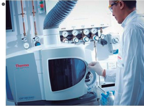
Instrumento de laboratorio ICP (Plasma Inductivo Acoplado) para análisis de agua
