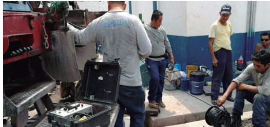
Registro eléctrico en pozo Jocoro
