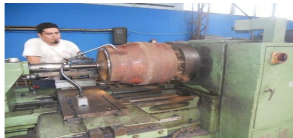
REHABILITACIÓN DE PIEZAS Y ARMADO DE TURBINAS EN EL TALLER DE ELECTROMECÁNICA DE ANDA
