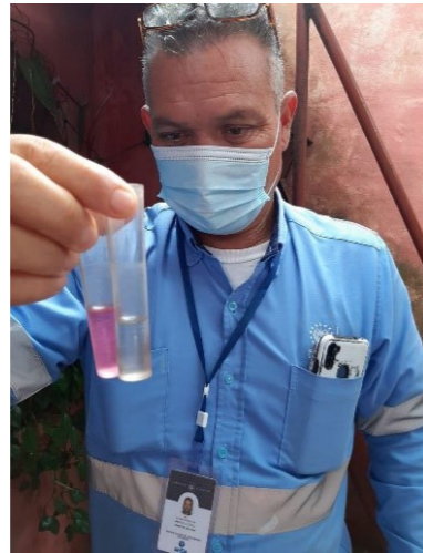
Lecturas de Cloro residual en red de distribución
