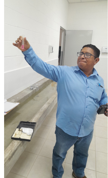
Lecturas de cloro residual en red de distribución
