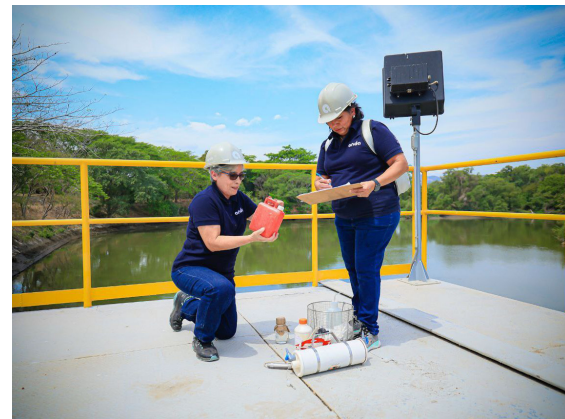
Personal del LATIL en medición de caudal, en bocatoma de la Planta Torogoz
