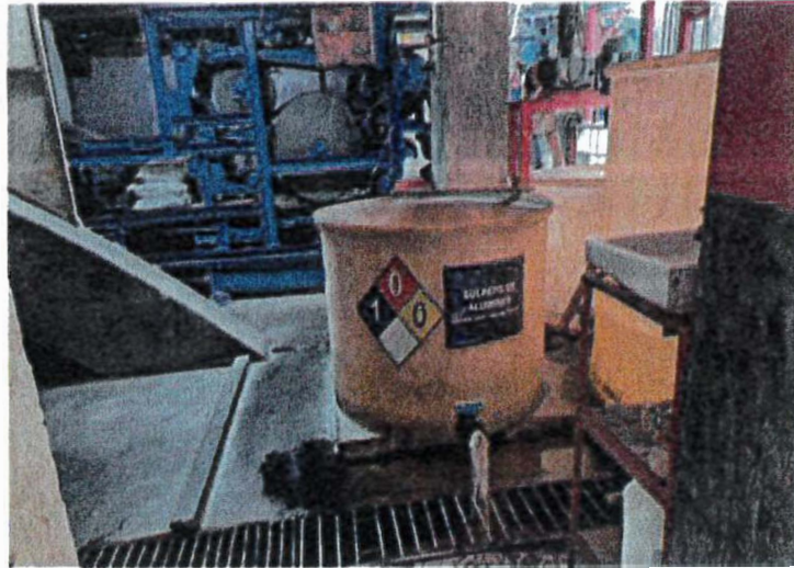
Ilustración 9. Adición de coagulante
