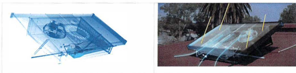
Figura 1. Esquema tipo del sistema de captura de Agua Atmosférica.
