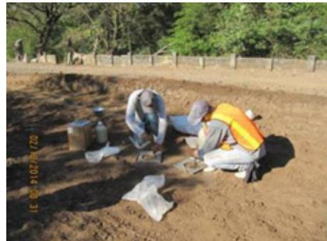
Verificación de la densificación en capa de suelo compactado, construcción de borda
