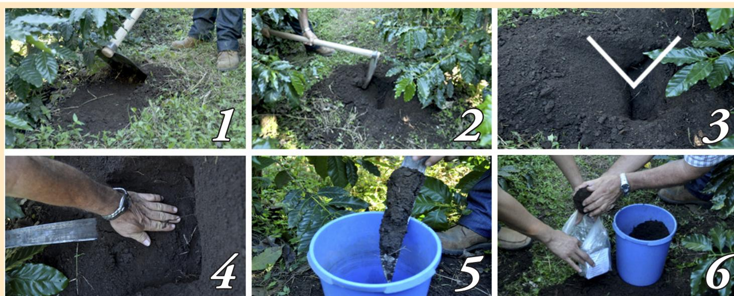
**1.** Limpia de banda de abonamiento. **2.** Apertura de hoyo de 20 cm de profundidad. **3.** Hoyo en forma de "V". **4.** Toma de la tajada de tierra de 2.5 cm de grosor. **5.** Colocación de sub-muestra en balde plástico. **6.** Mezcla de sub-muestras e identificación.
