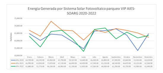
Con la información registrada se contabiliza que el Sistema Fotovoltaico con conexión a red ha generado 2,675.75 MWh lo que representa el consumo de 25,454 de viviendas con consumo promedio de energía 105 KWh/mes con esta energía generada se ha evitado la emisión de 668 toneladas de CO<sub>2</sub>.
