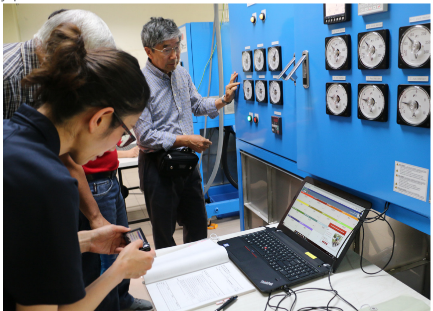
Figura No.10. Equipos didácticos de pequeñas centrales hidroeléctricas
