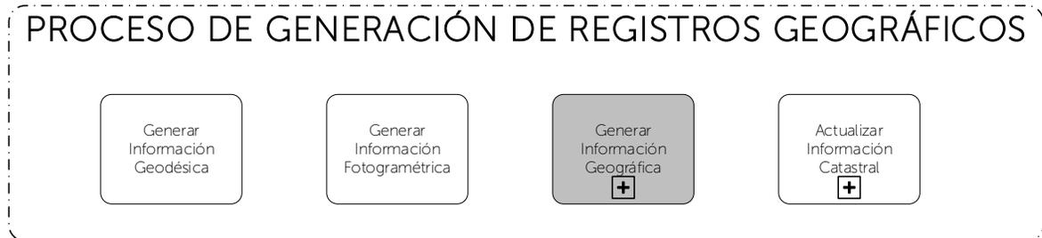
Consiste en la generación de información mediante la recolección de datos geográficos del territorio, basado en un modelo de datos y representado en un Sistema de Información Geográfica, orientado a dar respuestas a problemáticas reales, mediante la representación y análisis de los datos. Dentro de esta fase además se realizan dos importantes subprocesos: redefinición de límites municipales y delimitación de cantones y caseríos.
