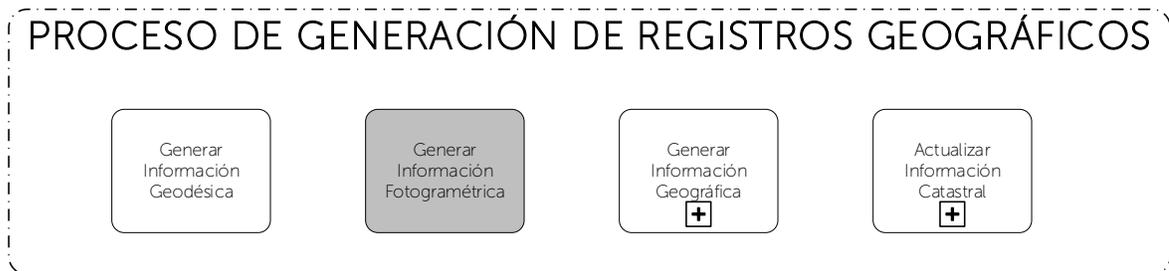
Consiste en la generación de datos cartográficos y geográficos, base para la producción y actualización del catastro y cartografía nacional a partir de la toma de fotografía aérea, hasta la producción de ortofotografías y restituciones fotogramétricas y modelos digitales del terreno. La información fotogramétrica generada es el insumo básico para la generación de mapas a escalas pequeñas y grandes, para usuarios internos y externos.
