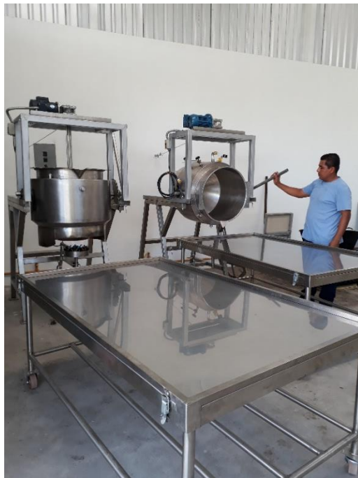
Dulcería La Fiesta: Incorporación de marmitas para la elaboración de dulce típico y mesas de corte para estandarizar la producción
