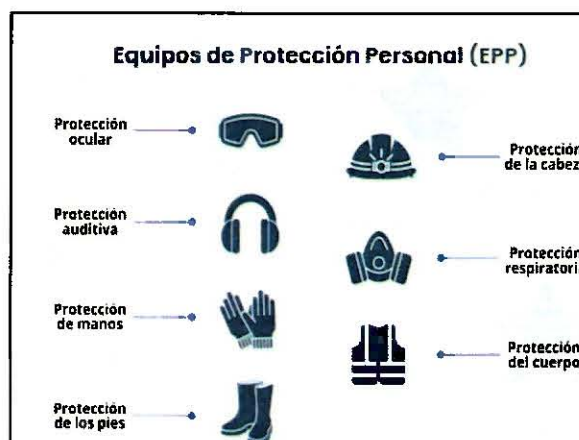
Imagen 9: Equipos de protección personal
