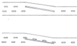
Diagrama 4 - Ejemplo de trazado de marcas en el lugar en que un camino de tres vías se transforma en uno de dos vías.
