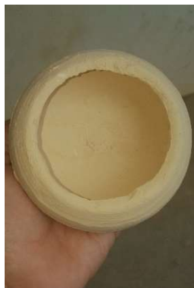
Muestra ya quemada a 800 grados centígrados de temperatura
