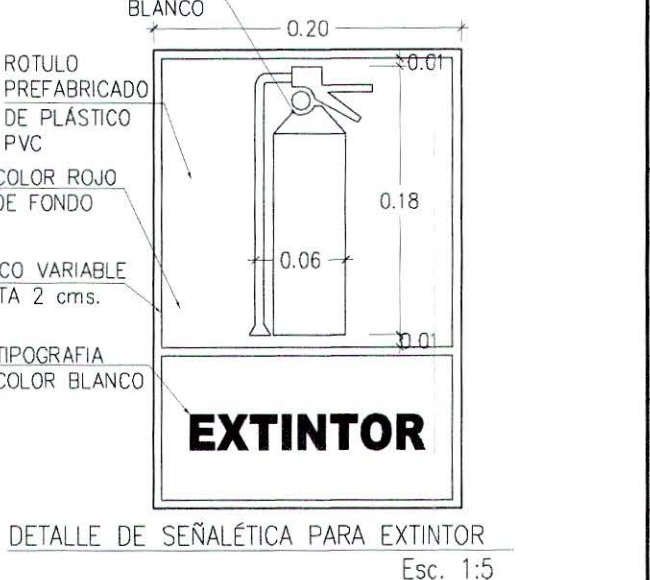
DETALLE DE SEÑALÉTICA PARA EXTINTOR Esc. 1:5
