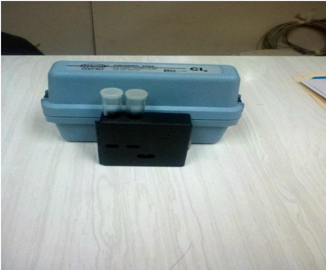
Medidor de Cloro
