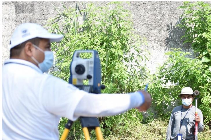
Medición topográfica y replanteo de puntos -Cubo IVU
