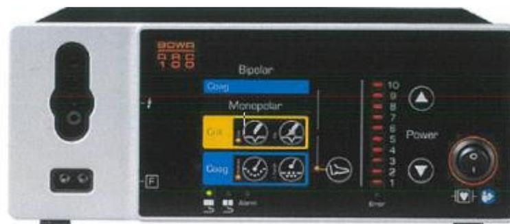
EL EQUIPO BOWA, MODELO ARC-100, MUESTRA INDICADORES QUE VAN DEL 1 AL 10, NO CUENTA CON PANTALLA DIGITAL POR LO QUE NO MUESTRA LA POTENCIA SELECCIONADA, ESTO CLARAMENTE PUEDE GENERAR CONFUSIÓN PARA CUALQUIER USUARIO.
