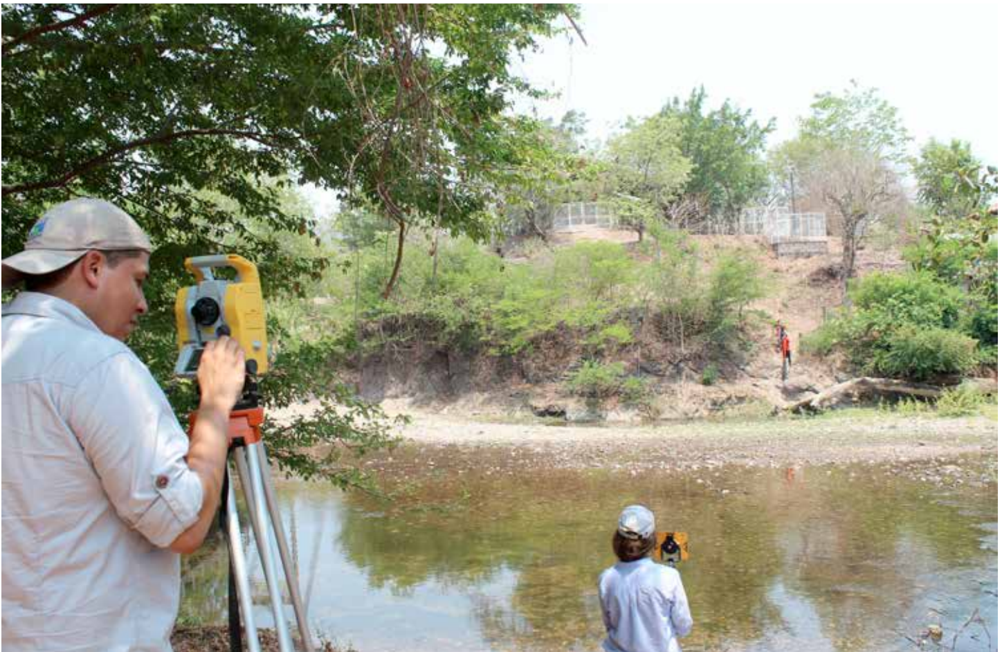
Medición topográfica de la sección transversal del río Angue
