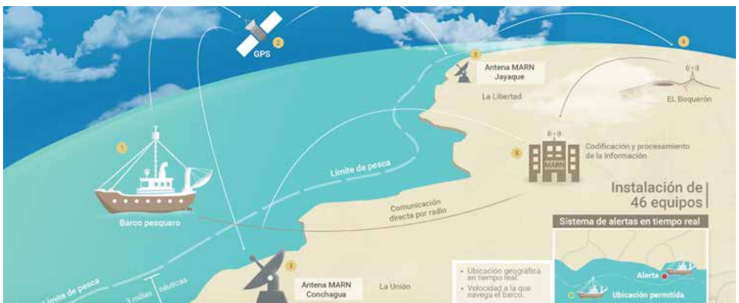
Figura 1. Infografía de la Instalación y el funcionamiento de GPS para vigilancia de barcos pesqueros
