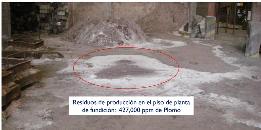
Residuos de producción en el piso de planta de fundición: 427,000 ppm de Plomo
