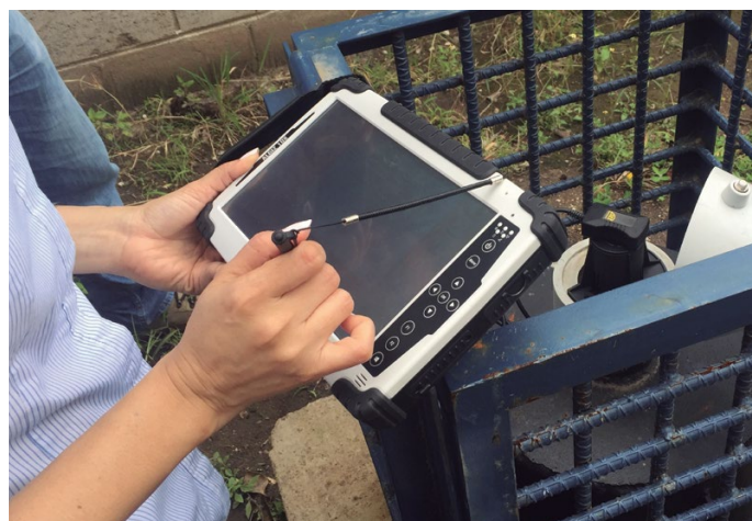
Figura 33. Proceso de descarga y configuración del equipo de monitoreo de pozos.
