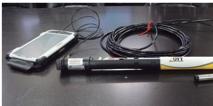
Figura 31. Equipo para medición continua de niveles de agua subterránea y temperatura en pozos
