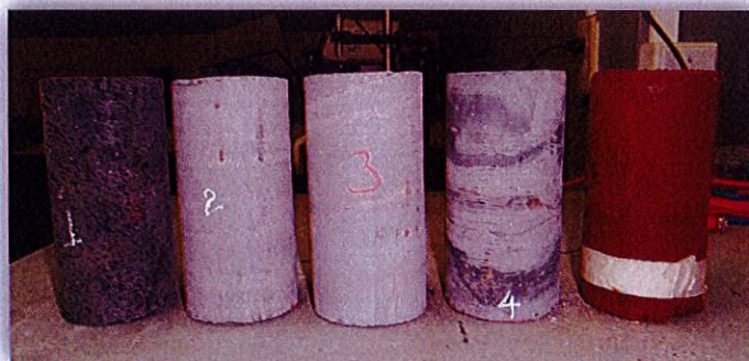
Muestras del sondeo rotativo R-02 preparadas para ensayo a compresión.
