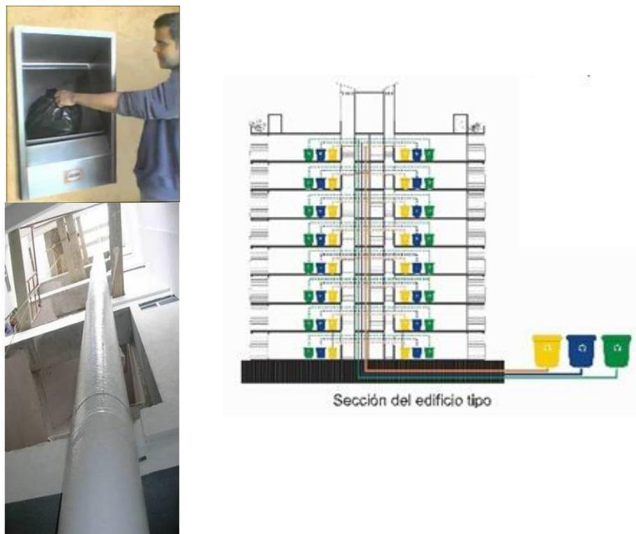
Figura N° 2. *Sistema shut para residenciales de altura*
