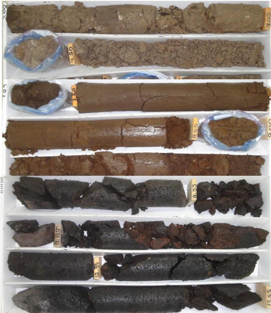
*Fotografía mostrando suelos predominantes y presencia de rocas basálticas intemperizadas en sondeo rotativo S-1R de 823.82-813.27 msnm.*
