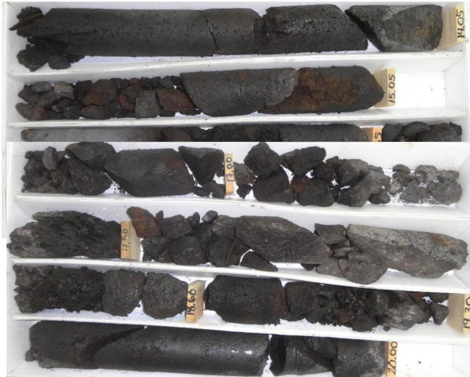
Fotografía mostrando presencia de rocas basálticas intemperizadas en Sondeo S-1R de 813.27-806.82 msnm.
