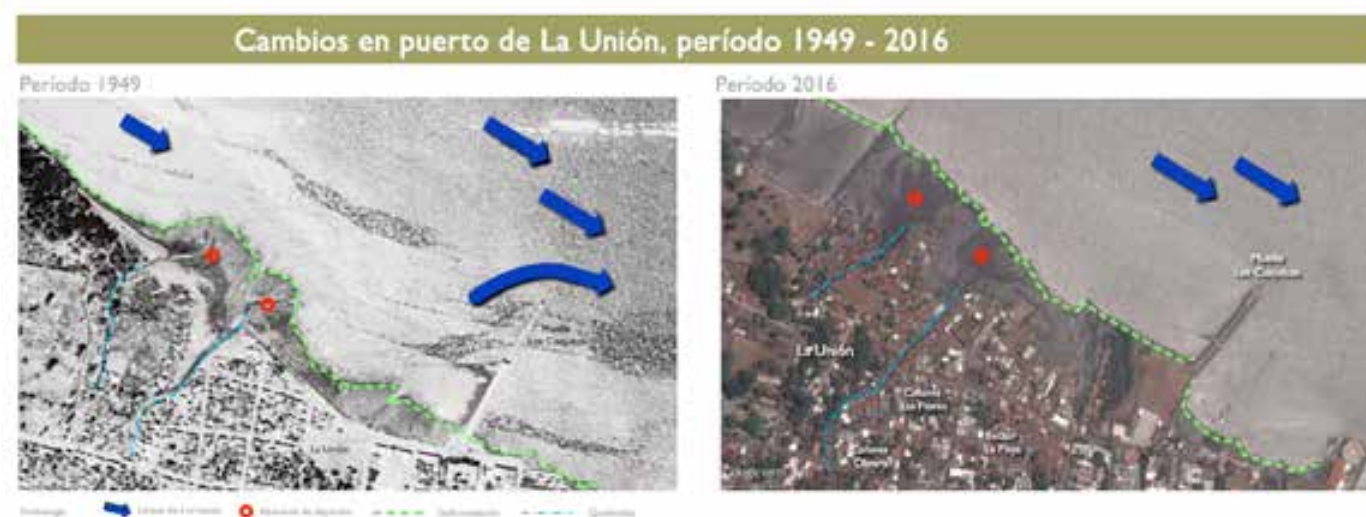
Figura 120. La imagen muestra la sedimentación en ciudad puerto de La Unión, como consecuencia de la construcción de muelles que interrumpen el flujo de líneas de corriente. Fuente: Imágenes de Google Earth y fotografías aéreas. Fuente: Elaboración propia MARN
