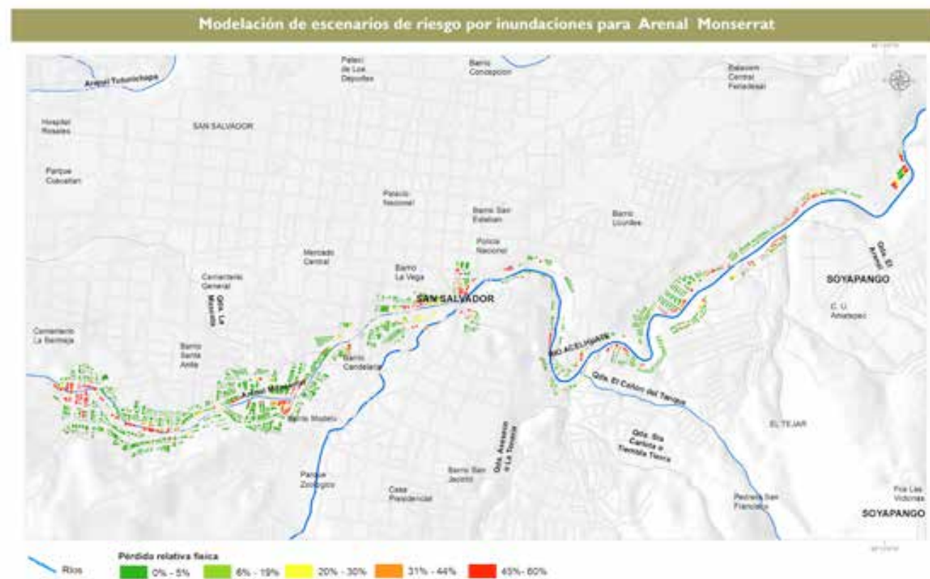
Figura 177. Mapa de pérdida relativa física de los tres tramos analizados en el río Arenal de Monserrat-Acelhuate Fuente: Análisis de Riesgo por Inundación en Cuencas Prioritarias y Perfil de Riesgo de Inundaciones. Resumen Ejecutivo MARN/BID, enero, 2015
