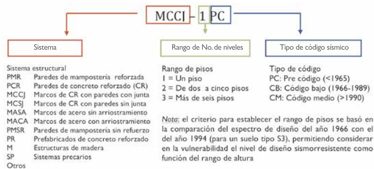
Figura 165. Codificación básica de tipologías constructivas Fuente: Modelación probabilista de escenarios de riesgo sísmico para el Área Metropolitana de San Salvador, 2012
