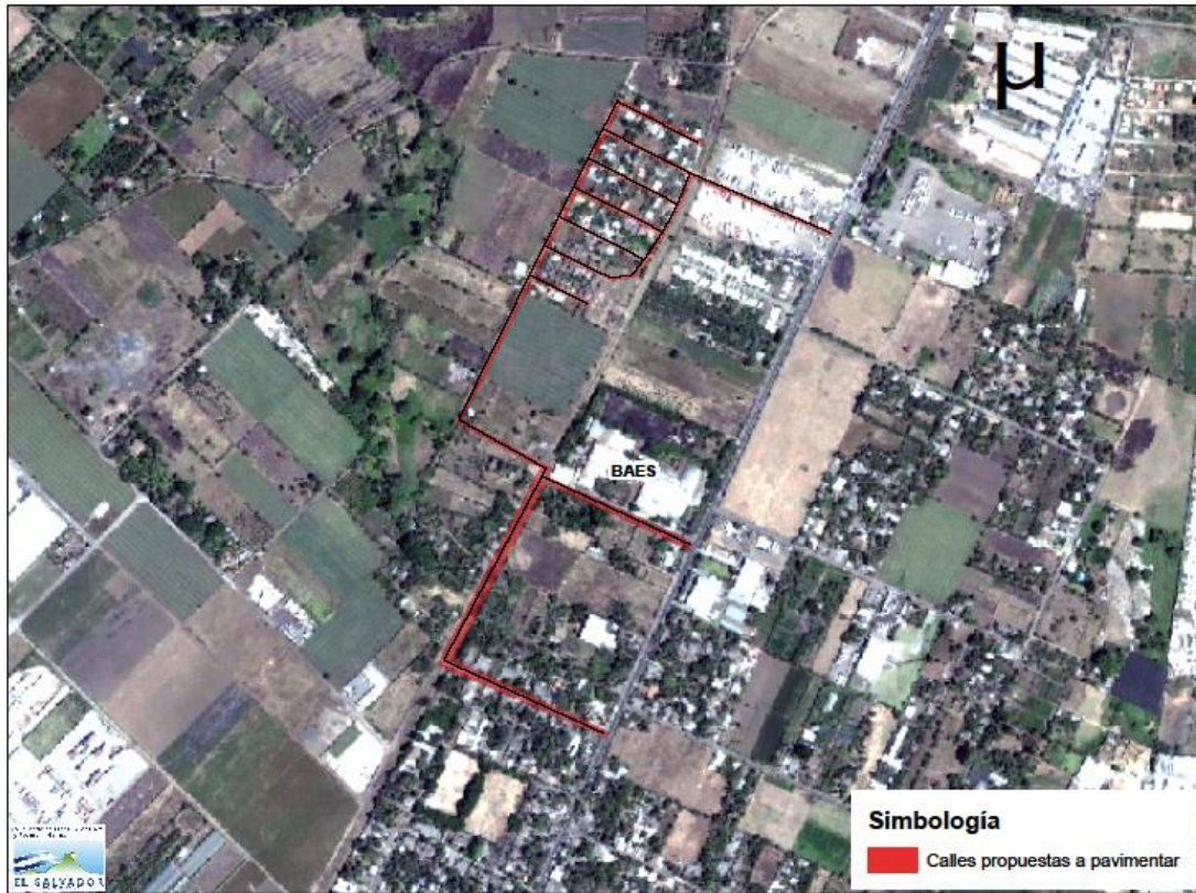
Figura 32. Mapa de calles propuestas a mitigación de riesgos de contaminación por plomo en seguimiento al DECRETO EJECUTIVO No.12, Estado de Emergencia Ambiental, 19 Agosto 2010 (Art.2: Sellado con imprimación asfáltica de 1,300 metros lineales de caminos y calles alrededor de las instalaciones de Baterías de El Salvador, S.A de C.V)
