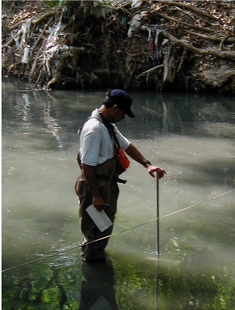
Figura 2. Medición de la velocidad de la sección parcial por unidad de tiempo. Fuente: MARN.
