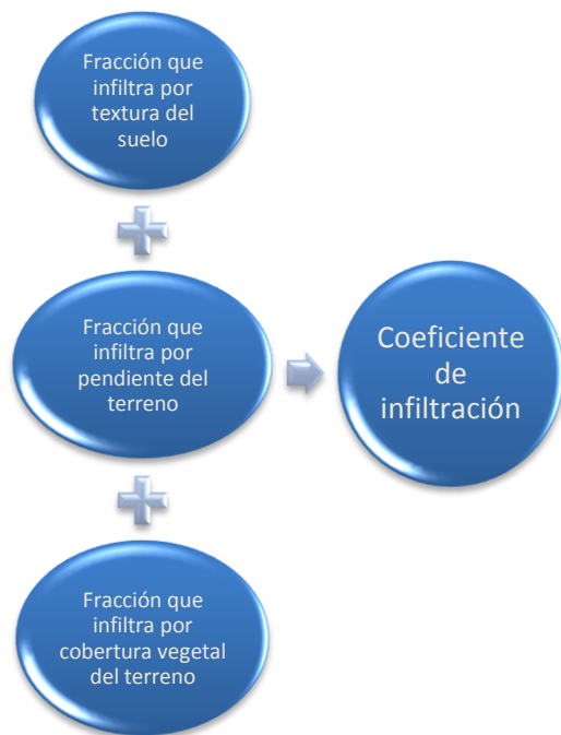
Figura 1 Obtención del coeficiente de infiltración para el cálculo de la recarga acuífera
