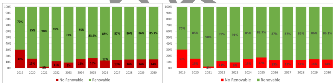
Figura III.3. Aumento de la proporción de energía eléctrica que se genera a partir de energías renovables (color verde) en la matriz de capacidad instalada del país, para 2025 y 2030, para el escenario de alta intensidad de descarbonización (panel izquierdo) y de baja intensidad de descarbonización (panel derecho), en comparación al año base (2019). Fuente: CNE.
