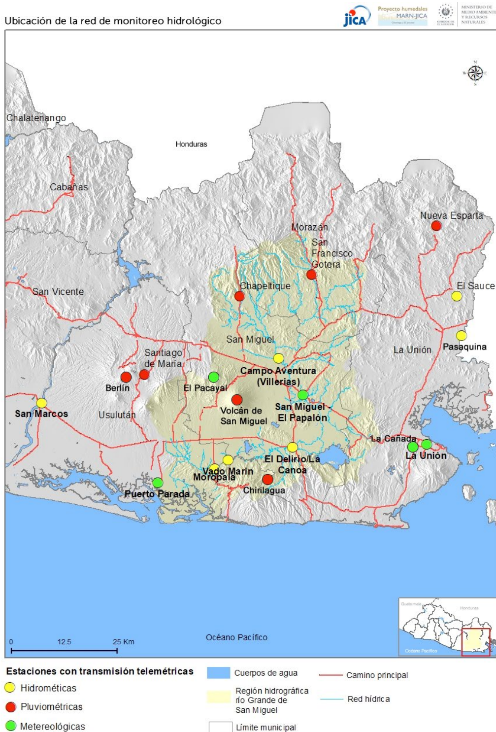
Figura 62. Ubicación de la red de monitoreo hidrológico para el pronóstico de inundaciones y el Sistema de Alerta Temprana en el río Grande de San Miguel, identificada con puntos rojos. Fuente: MARN, 2017.
