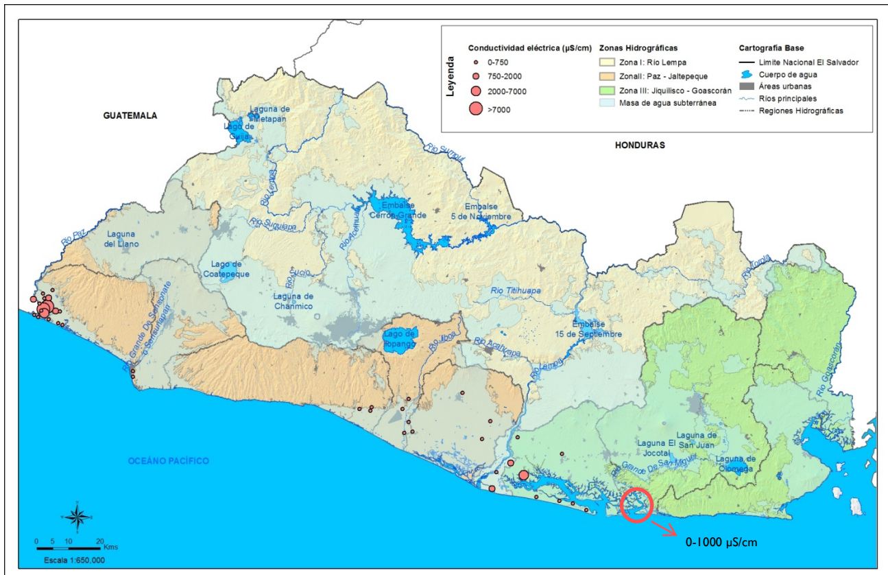
Figura 61: Resultados de conductividad ( \mu\text{S}/\text{cm} ). Fuentes: (GM-UNES, 2013), (MARN, 2013) y (ANDA, 2013).
