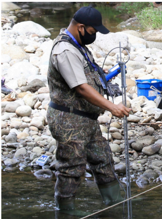
Figura 2 Medición de la velocidad de la sección parcial por unidad de tiempo.
