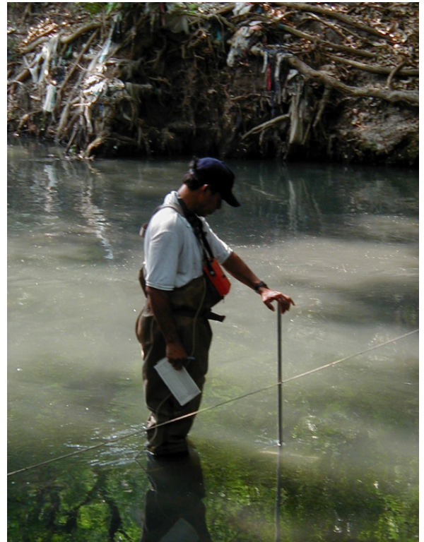
Figura 8. Medición de velocidad de la sección parcial por unidad de tiempo Fuente: MARN
