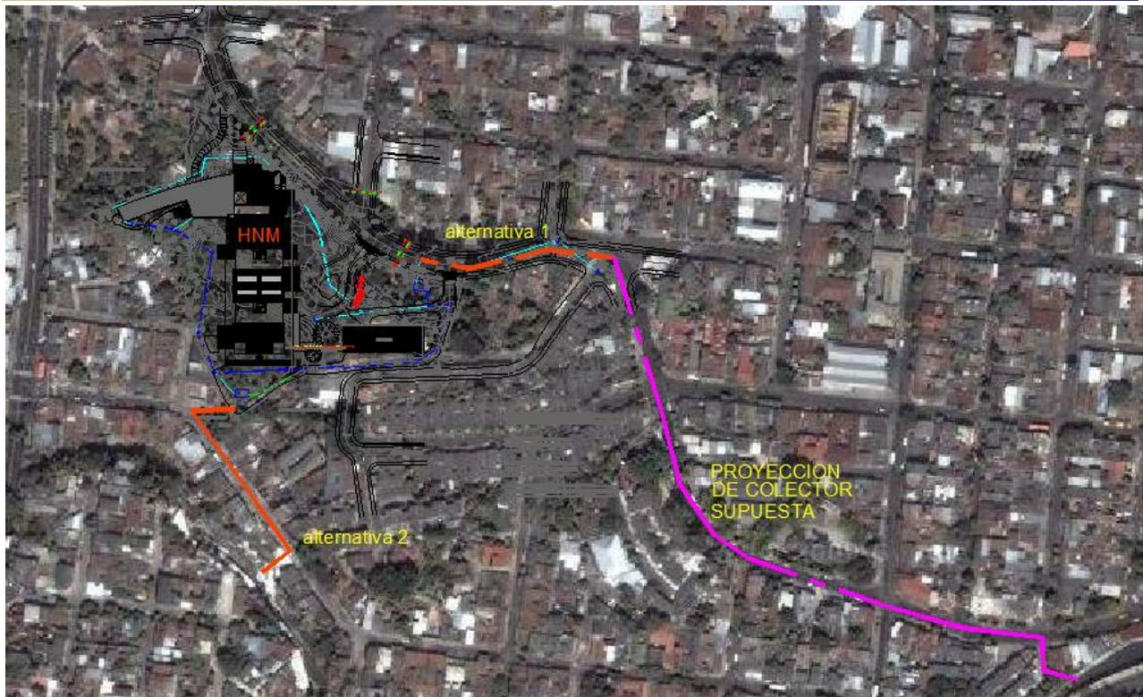
Figura 2.7 Alternativas 1 y 2 para la descarga del drenaje pluvial.
