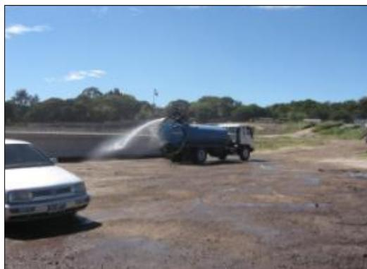
**Figura 6.4 Camión cisterna con equipo de bombeo similar al que sería utilizado para el control de finos durante las actividades de construcción.**
