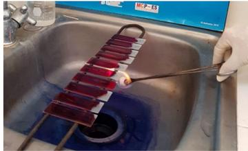
2. Calentar hasta obtener 3 emisiones de vapor. Apagar antorcha y esperar completar 5 minutos.
