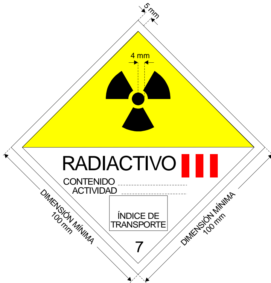
FIGURA 4. Etiqueta para la categoría III-AMARILLA. El color de fondo de la mitad superior de la etiqueta será amarillo y el de la mitad inferior blanco, el trébol y los caracteres y líneas impresos serán negros y las barras que indican la categoría serán rojas.
