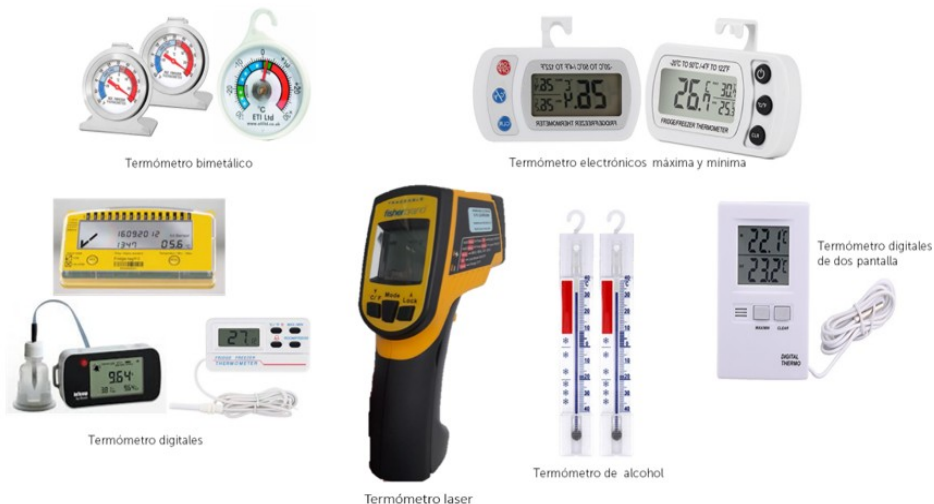
Figura. 10: Termómetros utilizados para monitorear en los equipos de refrigeración
