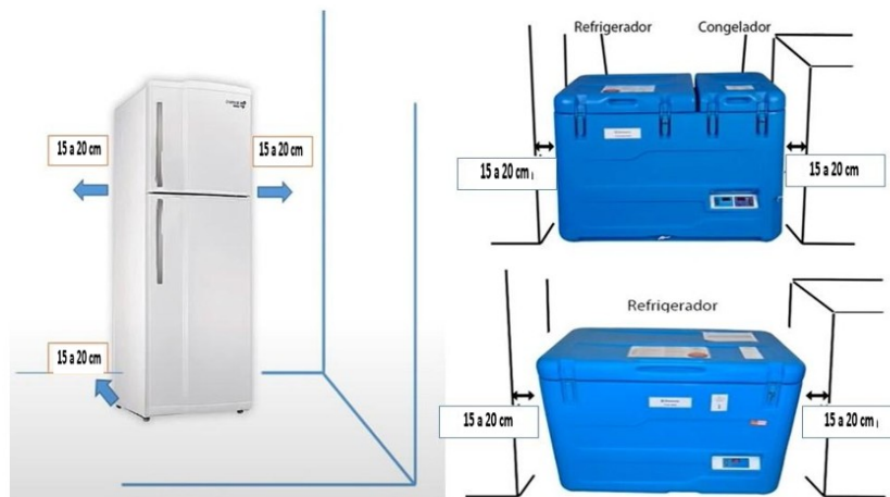
Figura. 11: Esquema de distanciamiento mínimo de los refrigeradores de la pared y otros equipos
