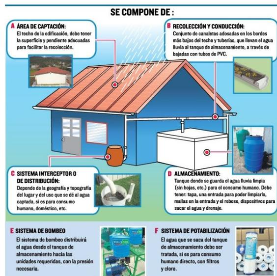
Es posible disponer de los elementos esenciales para la captación de las aguas lluvias en las parcelas, especialmente en las zonas rurales, por el tamaño de los lotes. Los elementos esenciales se muestran en la Imagen 6.1 y son: Área de captación, Recolección y conducción, Sistema interceptor o de distribución, Almacenamiento, Sistema de Bombeo (en caso sea necesario) y Sistema de Potabilización (si aplica por el uso).
