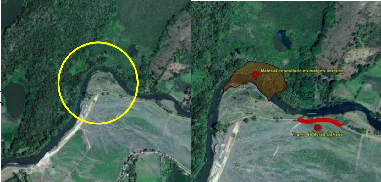
Figura 6 y 7. A la izquierda se intensifica ampliación de meandro imagen de 3 de Febrero de 2011. A la derecha se observa la acumulación de material en margen derecho por ampliación de meandro.
