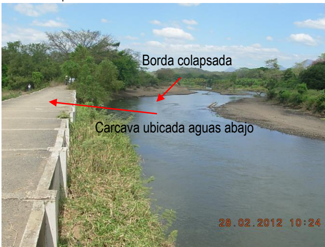
Fotos 3 y 4 Obsérvese la cantidad de material arenoso depositado en el sitio inspeccionado y la cárcava formada a unos 150 m aguas abajo de lugar en donde se ubica la borda colapsada.
