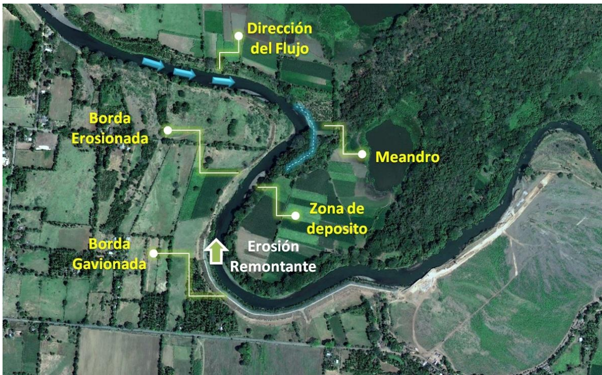
Figura 9 Vista de la zona en donde se encuentra la borda erosionada en el sector de El Colorado. Se muestra cómo se desarrolla la dinámica de agradación y degradación por efecto de la borda ubicada aguas abajo y la interacción entre los dos meandros.
