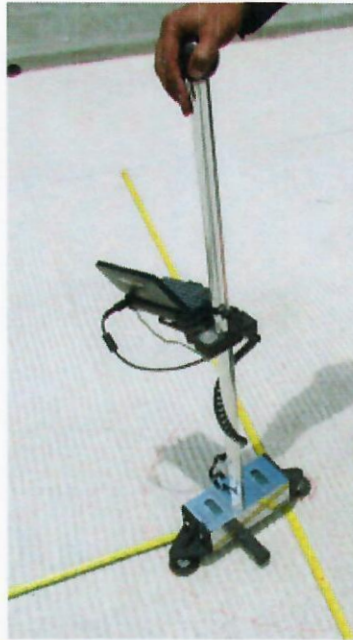
Fotografía 2. Equipo Perfilómetro Manual (Dipstick) de la DIDOP
