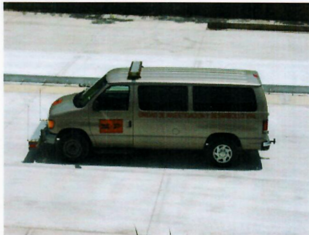
Fotografía 1. Equipo Perfilómetro de Referencia Inercial de la DIDOP (Road Surface Profiler, RSP, por sus siglas en inglés)
