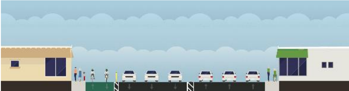
Imagen 27. Sección propuesta para tramo El Trébol-Redondel Utila.. Fuente: MNM - DIIS/MOP, 2014.
