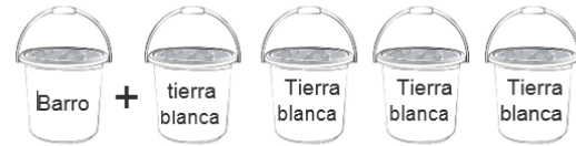
Figura 1.7. Proporción para adobes usando tipo tierra blanca y barro y/o arcilla.
