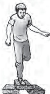
Prueba de resistencia de unidades de adobe
