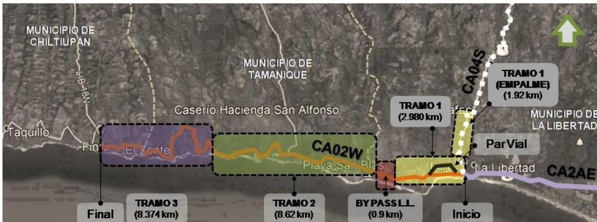
**Figura V.3.1.** Tramos en los que se dividirá el diseño del proyecto para su ejecución.
